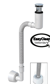
TB33-40 Integrerat vattenlås med Popup (krom) för enkel rengöring. Flexslang för vägg/golv anslutning.
